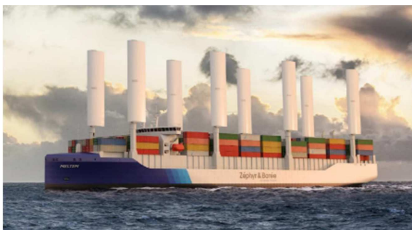
Figure 36 : Exemple de cargo polyvalent à voiles rigides sous armement Zéphyr & Borée
